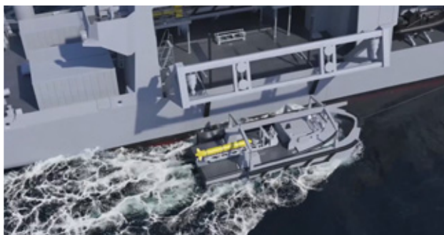
Modélisation d'un système LARS intégré sur un navire
