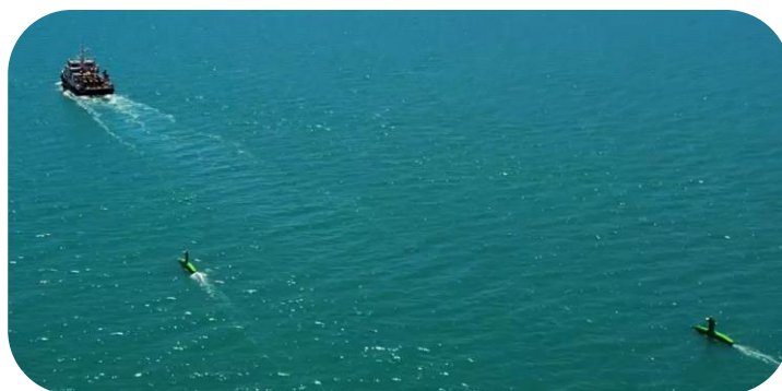
Opération de survey utilisant 2 drones DriX déployés depuis un navire d'hydrographie traditionnel
