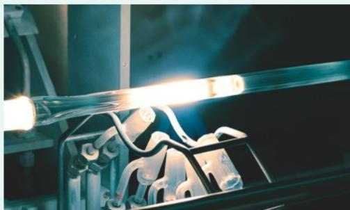
Fabrication de fibres optiques spéciales à Lannion
