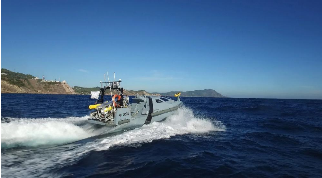
Drone de surface USV Inspector 90 et son système de Launch & Recovery
